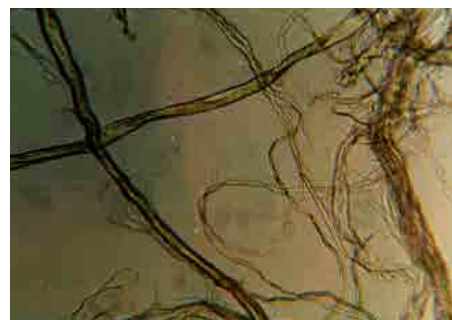
عکس شماره ۸- الیاف کاغذ قرآن نمونه ۱، رنگ آمیزی با معرف ویلسون، بزرگنمایی ۱۰۰X.
