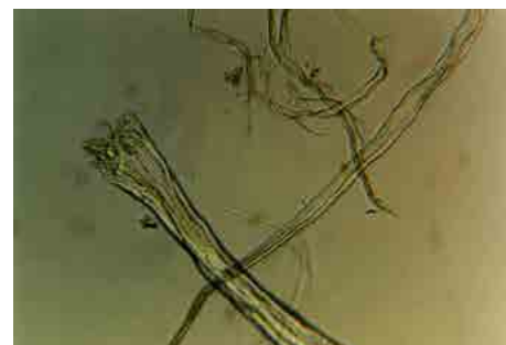
عکس شماره ۱۴- الیاف کاغذ قرآن نمونه ۱، رنگ آمیزی با معرف گراف C، بزرگنمایی ۲۰۰X.
