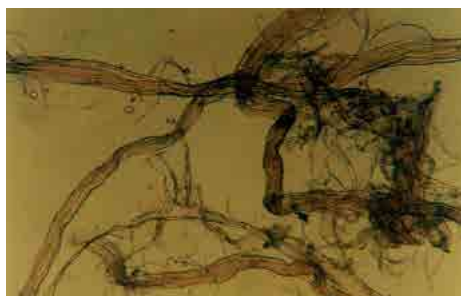
عکس شماره ۱۰- الیاف کاغذ قرآن نمونه ۱ ، رنگ آمیزی با معرف هرزبرگ، بزرگنمایی ۱۵۰X.
