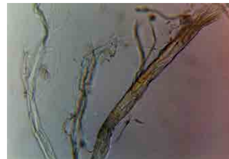
عکس شماره ۱۵- الیاف کاغذ قرآن نمونه ۲، رنگ آمیزی با معرف گراف C، بزرگنمایی ۲۰۰X.
