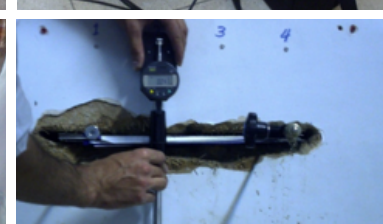
مجموعه تصاویر ۳۰: آزمایش دبل فلت جک
